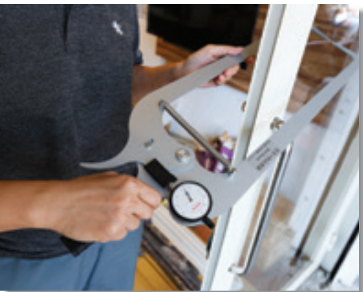
透過這台要價十幾萬元的現場檢驗玻璃厚度儀器，可以立即檢測出烤漆的厚度。
