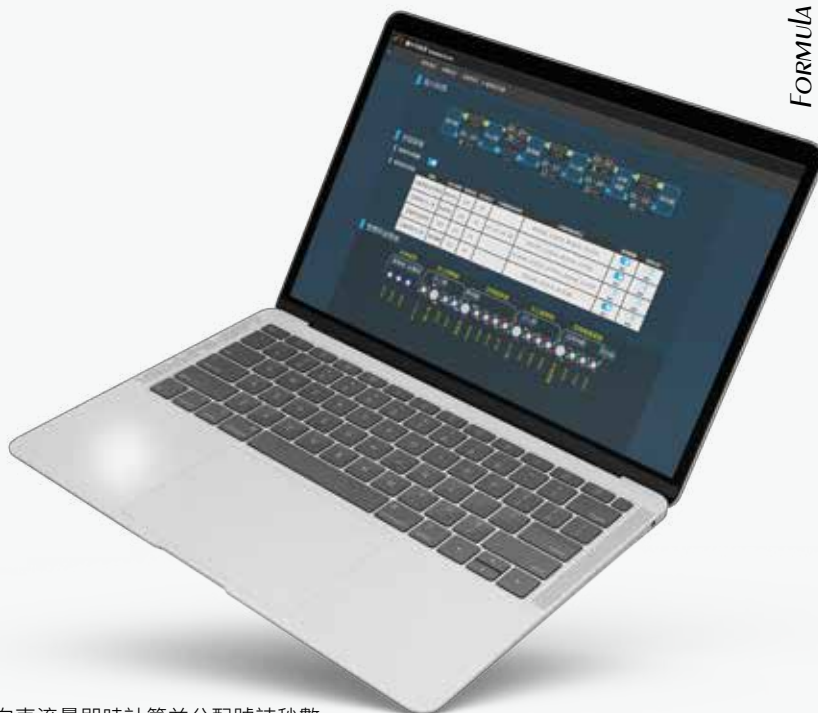
智慧化動態號誌系統依據各方向車流量即時計算並分配號誌秒數
