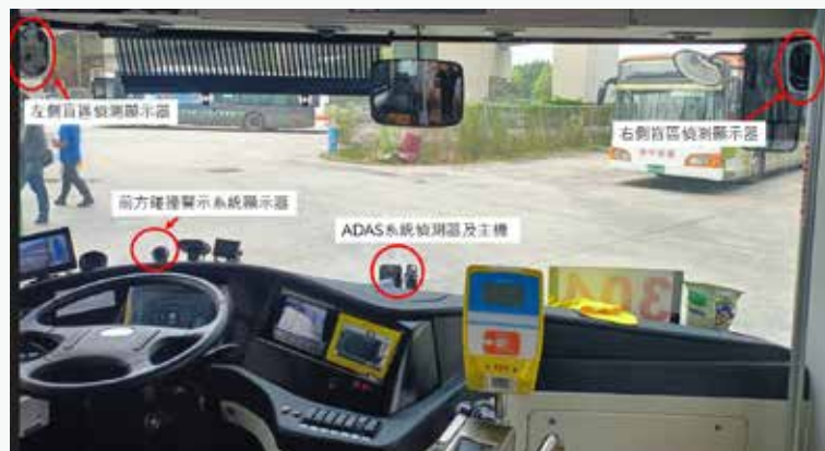
先進駕駛輔助系統可利用感測器偵測車體周遭環境，提醒駕駛留意路況
