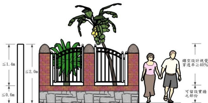
圖六 住宅區鏤空圍牆參考圖(修訂前)
