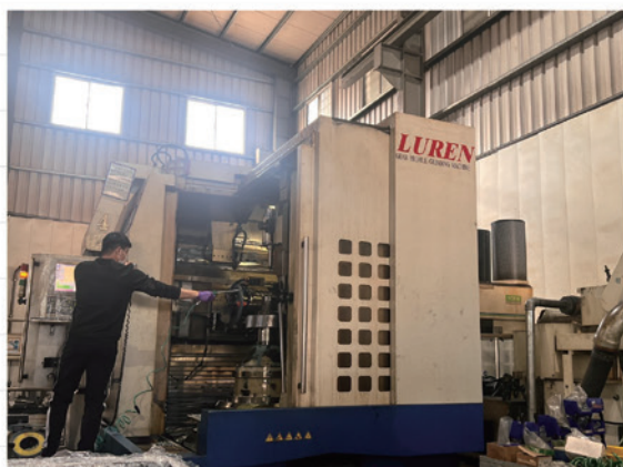
超正齒輪區內的陸聯（LUREN）CNC齒輪磨齒機，具備數位化參數設定與加工數據即時回傳功能，未來透過機聯網串接，可將加工參數、刀具壽命及產出數據整合至生產管理系統，實現製程可視化與智慧排程。
