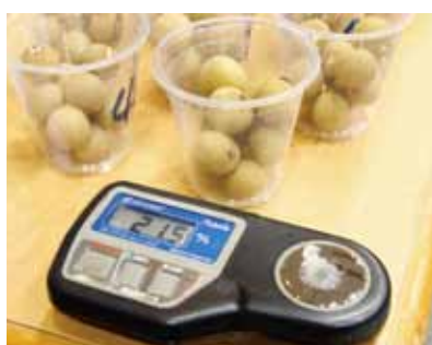
▲將汁液放置甜度計上以儀器測試糖度
