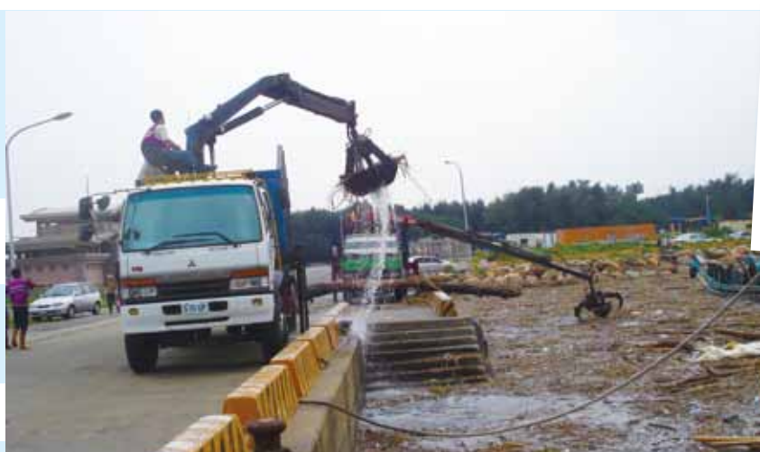
▲抓斗型吊卡車打撈漂流物上岸之情形
