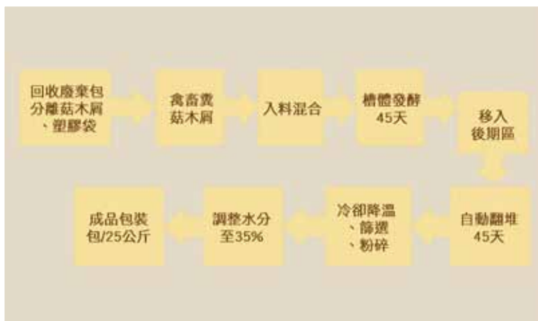
▲回收廢棄菇類太空包再利用流程圖
