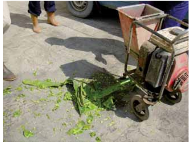
▲修剪後的病枝需要移除，以免病原在園區擴散，利用碎枝機攪碎掩埋為解決方法之一
