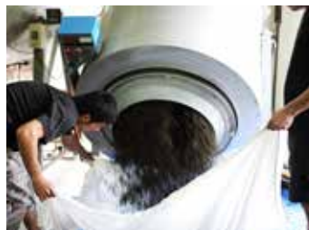
3. 茶磚甩入滾筒機中打散，此步驟取代傳統團揉。
