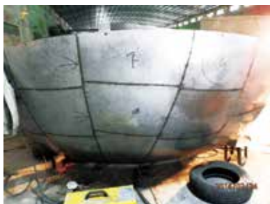
不鏽鋼板錘鍛、焊接
