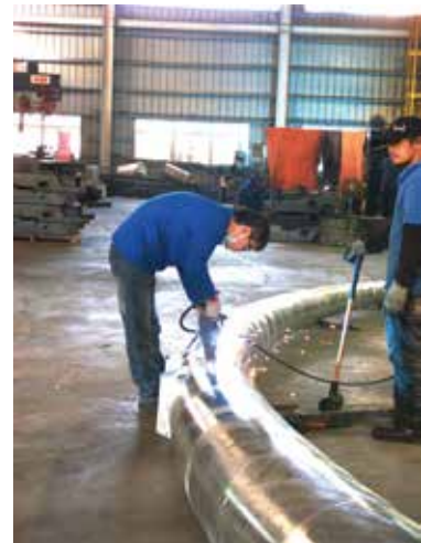
製作過程－彩虹彎管焊接
