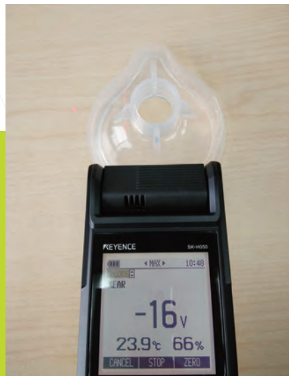
● 利用靜電量測儀量測靜電數值，數值越低代表抗靜電能力越好
