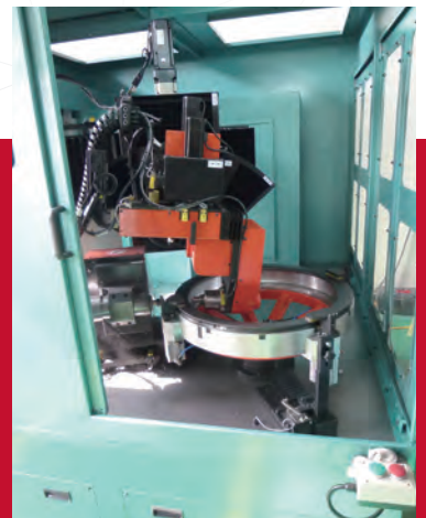
● 輪圈自動鑽孔機 (內部)
