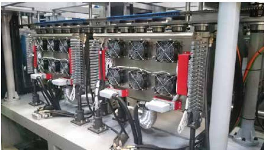
▲圖 1、瓶胚輸送加熱及瓶胚轉送系統
