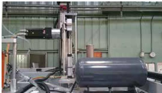
▲圖 3、拉伸吹製成形系統成品
