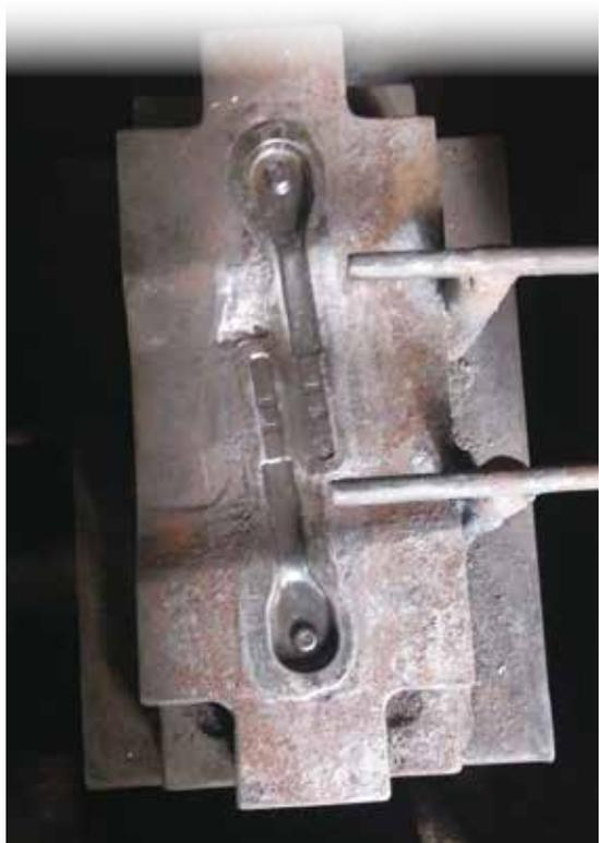
▲ LED 防水照明棘輪板手之鍛造模具
