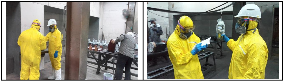
圖 2 通風工程改善前，無裝設活動伸縮式棚架，PID 量測現況
