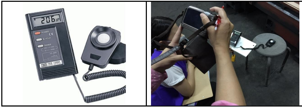
圖 2 改善前，區域 A 與 B 整體照明光度量測現況
