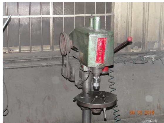
圖 2 立式鑽床傳動皮帶無護罩。
