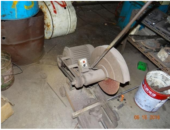
圖 3 切割機傳動皮帶無護罩。
