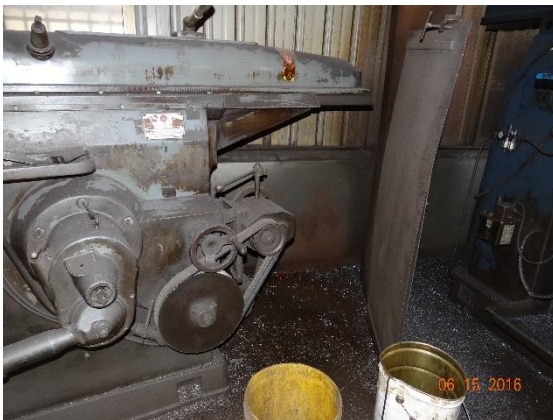
圖 1 牛頭刨床傳動皮帶無護罩。
